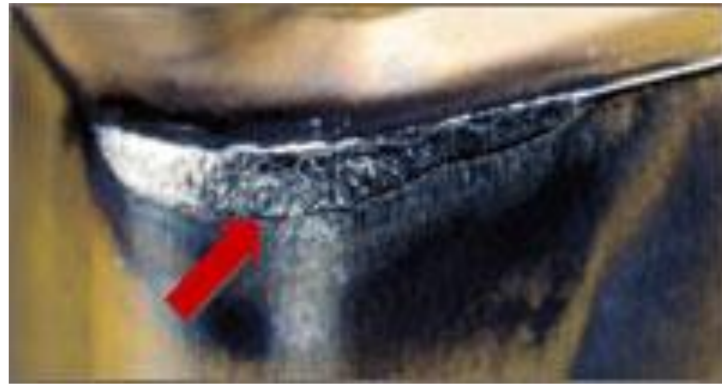
Desgaste de flanco
